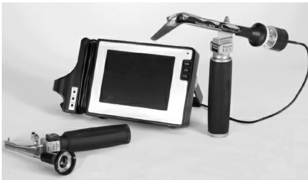
● FIGURA 15-6. El laringoscopio óptico Truview PCD con cámara de video adaptado al ocular de una de las hojas.
