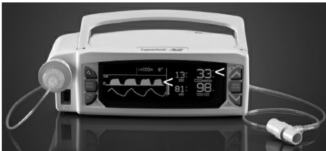
● FIGURA 8-1. Capnógrafo con trazo de onda. La pantalla muestra la cifra de PETCO 2 (<) con cada respiración y los trazos (<) representa las concentraciones espigadas de CO 2 con el paso del tiempo.
